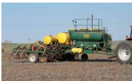
Koringplanter met 1000L tenk vir kompostee. Die kompostee word met 'n diafragma pomp uitgepomp.
